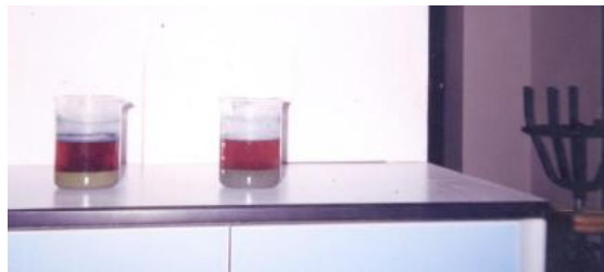
รูปที่ 4 น้ำย้อมคราม เตรียมโดยวิธี zinc lime vat
