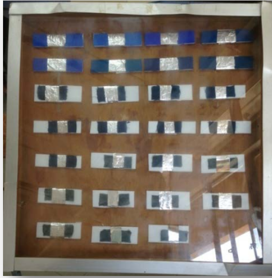
ภาพที่ ก21 การเตรียมผ้าตัวอย่าง เทียบกับผ้ามาตรฐาน ทดสอบความคงทนต่อแสงแดด
