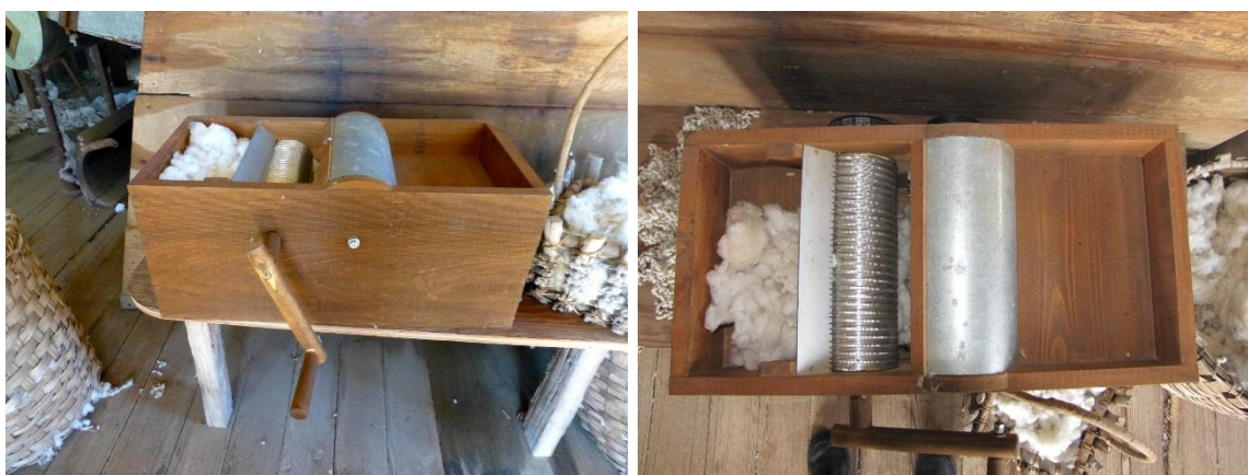
ภาพที่ 2.5 เครื่องหีบฝ้ายแบบลูกกลิ้ง (Phil and Ellie, 2014)
